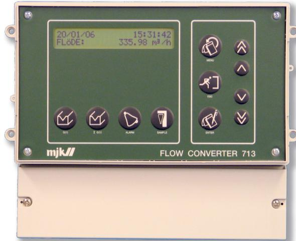
På flödesmätaren finns fyra funktionsknappar för avläsning:
