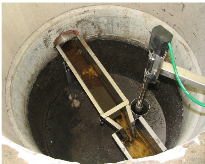
H-ränna för mätning i brunn. Försedd med mätkammare och tryckgivare.
